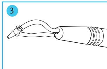
**IMPORTANT:** Les embouts jetables ne doivent être utilisés qu'une seule fois. Lors de la mise en place d'un nouvel embout, s'assurer qu'il est bien enclenché dans la buse de coupe comme l'indique la figure. Lire et suivre les instructions du manuel d'instructions du Quattro. JETER L'EMBOUIT APRÈS UTILISATION.
