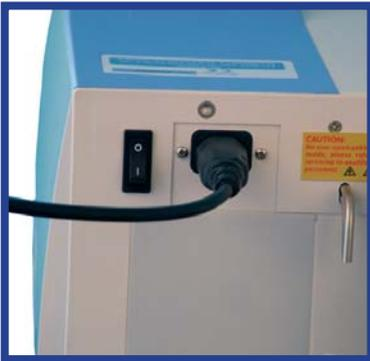
2. **Branchez le cordon d'alimentation électrique et mettez l'appareil sous tension. La machine lancera alors un cycle à grande vitesse d'environ 2,5 minutes.**
