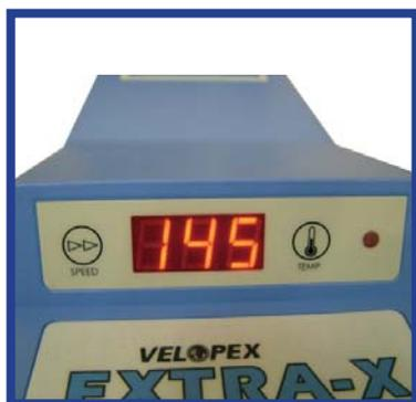
**14.** À titre de référence, la machine affichera un compte à rebours en secondes dès le début et jusqu'à la fin du développement. Le premier cycle après la mise sous tension de la machine sera un cycle rapide de test qui durera 150 secondes. Chaque cycle, par la suite, durera 300 secondes à moins que le « Cycle à grande vitesse » soit lancé (voir le début de la page 15).
