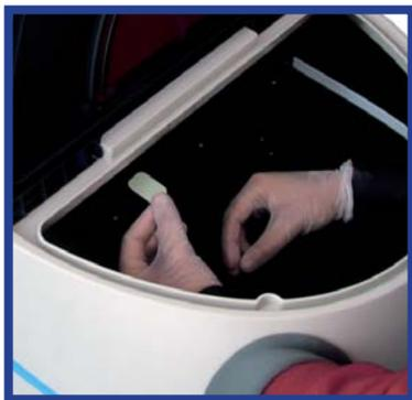
**12.** Lors de l'utilisation de la fonction endo, insérez un film endo-buccal dans la quatrième fente à partir de la droite sur le guide de chargement de films.
