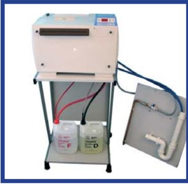
**14.** À chaque démarrage de la machine, une charge de produit chimique sera injectée dans la cuve de la machine. Le trop-plein retournera dans les mêmes bidons.
