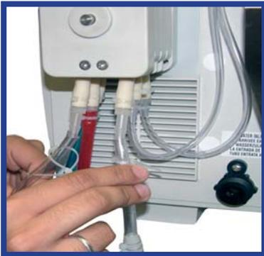
**15.** Pour la régénération de l'eau, retirez les tuyaux de l'emballage. Trempez les extrémités des tuyaux dans une tasse d'eau bouillante pendant au moins 30 secondes, puis insérez-les rapidement sur les embouts. Vissez le connecteur coudé sur l'entrée d'eau.
